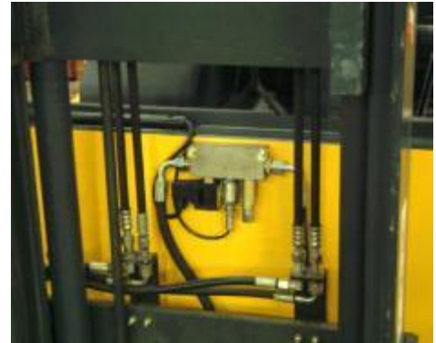
Montierter Ventilblock, Drucksensor und Senkventil
