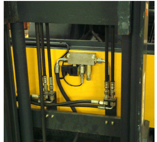
Montierter Ventilblock mit Drucksensor und Senkventil
