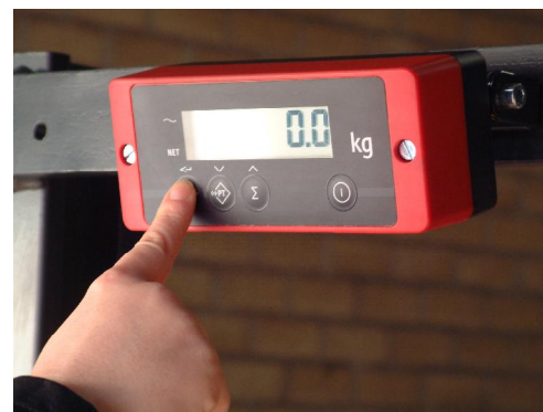
Anzeige im Gehäuse nach Schutzart IP 65
